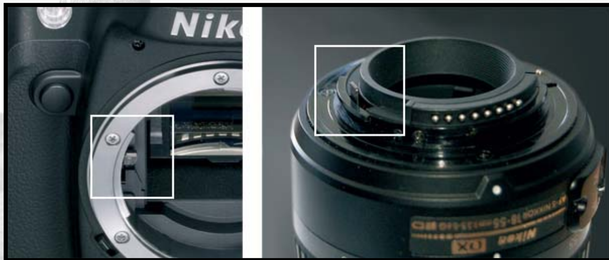
la leva comando del corpo macchina e la corrispondente leva sull'obiettivo
