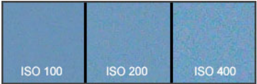
In questa immagine si nota che aumentando il valore ISO compare del rumore. Il rumore è particolarmente visibile nelle aree di colore uniforme, come ad esempio il cielo. Il rumore è dato dall'amplificazione del segnale, che porta conseguentemente a una amplificazione del rumore di fondo.
