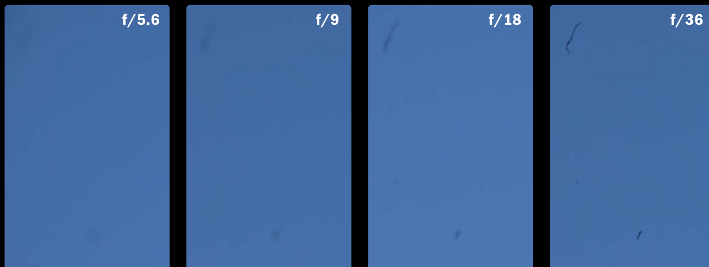
Immagini eseguite alle seguenti aperture di diaframma: f/5.6, f/9, f/18, f/36. Come si può vedere da questi particolari chiudendo progressivamente il diaframma si nota maggiormente lo sporco.
