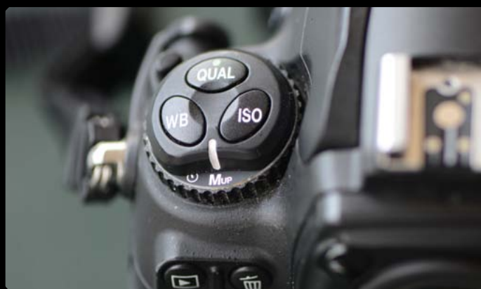
Alzare lo specchio elimina le, sia pur minime, vibrazioni date dal suo movimento al momento in cui si attiva l'otturatore. Le reflex hanno un apposito comando per questo scopo.
